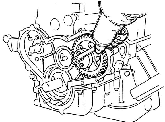
REMOVE THE INJECTION PUMP DRIVE GEAR
